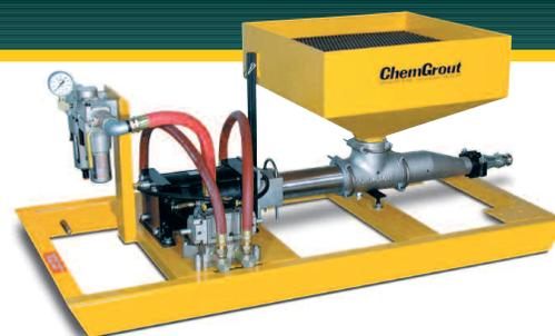
El CG-030 con pistón de bomba combina un sistema completo de enfoscado con una pala de mezclado altamente eficiente para proveer una salida del material continua. Ambos, el mezclador y la bomba están equipados con su correspondiente control de velocidad variable.
