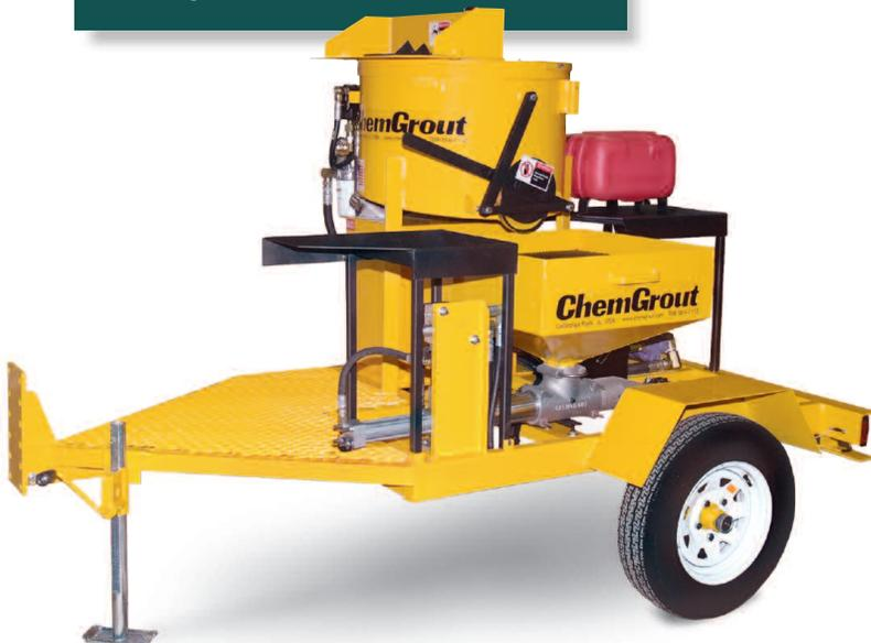
Sistema de un solo operador, tanque para mezclar de 45 galones (170 litros), tolva de almacenamiento grande y controles localizados centralmente que permiten a un solo operador mezclar, transferir y bombear para una producción continua.
