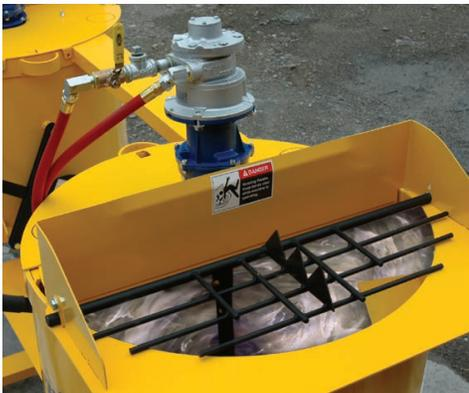
Tanque de mezcla especialmente diseñado que provee una elevada acción de cizallamiento para una humectación de partículas cuidadosa y completa, produciendo un mortero superior.
