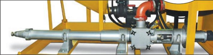
La bomba de cavidad progresiva de garganta cerrada de aleación de aluminio de ChemGrout brinda un fácil acceso a los cuatro lados del alojamiento de succión, brindando una fácil limpieza y mantenimiento.
