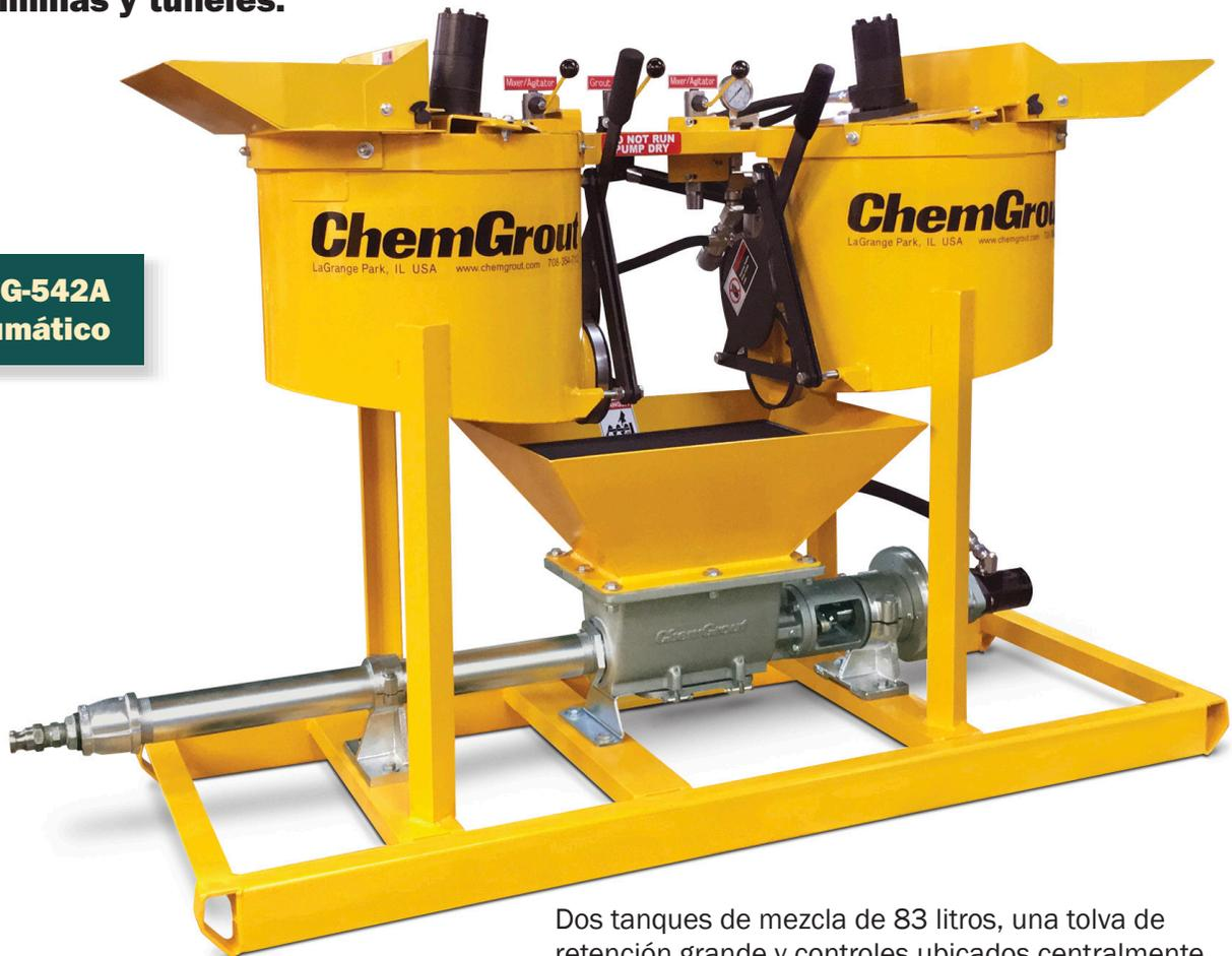
Dos tanques de mezcla de 83 litros, una tolva de retención grande y controles ubicados centralmente permiten a un solo operador una operación continua.
