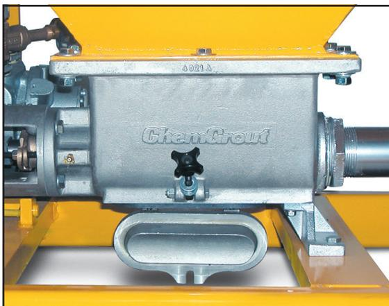
El puerto de limpieza con bisagras permite al operador un fácil acceso para el mantenimiento y la limpieza.
